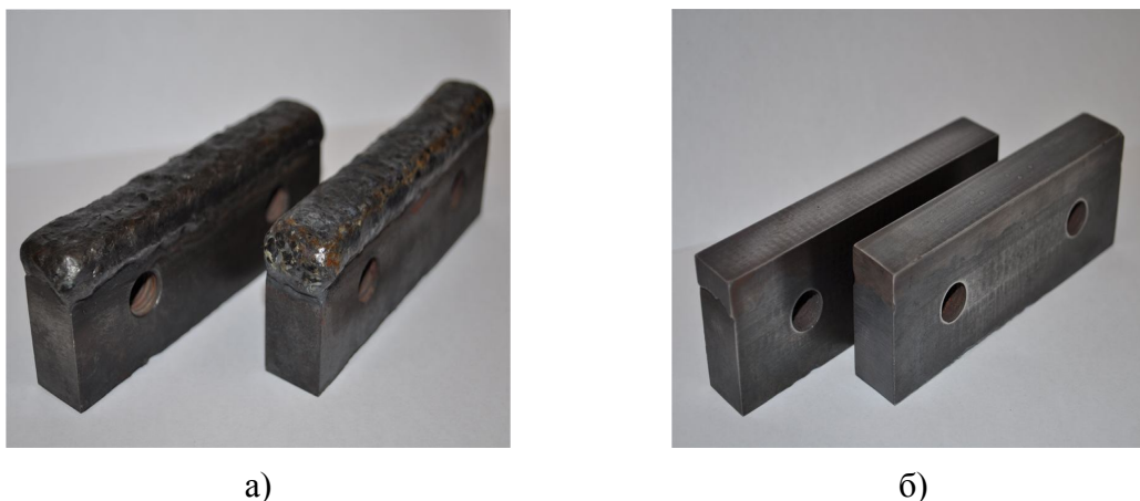
Рис. 3. Общий вид ножей для резки арматуры: после наплавки (а) и механической обработки (б)
