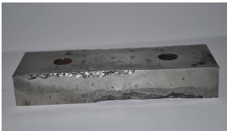
Рис. 1. Вид изношенного ножа для резки арматуры
